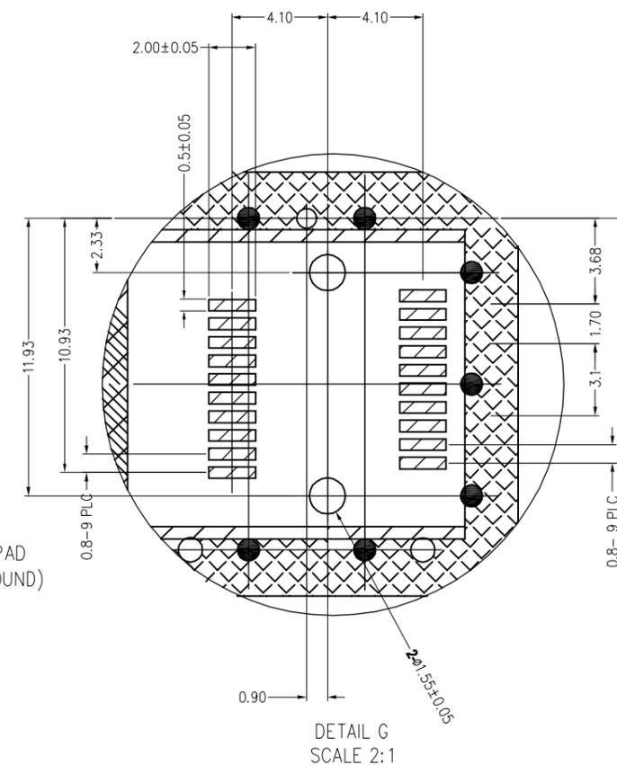
RECOMMENDED PCB LAYOUT (COMPONENT SIDE VIEW)
